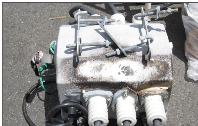
落雷で焼損したPAS
